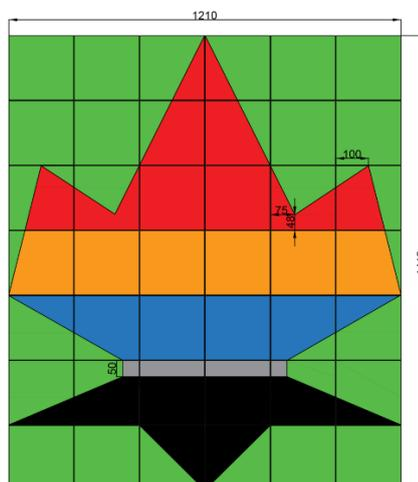
Длина облицовываемой поверхности стены – 1210 мм.
